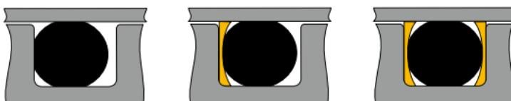
Parbak®-Stützringe verhindern die Extrusion in Hochdruckanwendungen, tragen zum Erhalt des Schmierfilms bei und verlängern somit die Lebensdauer von O-Ringen.
