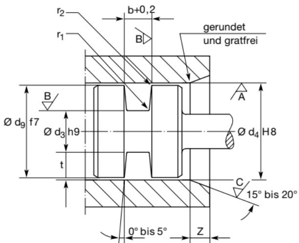
Kolbendichtung – Hydraulik
