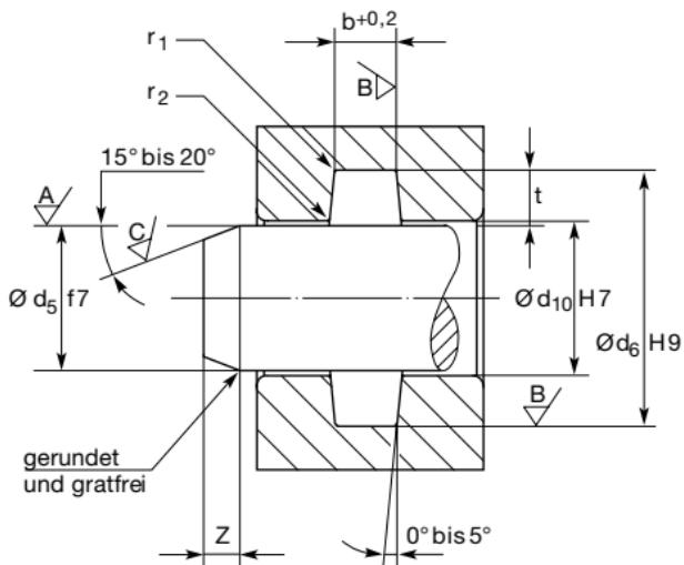
Stangendichtung – Hydraulik
